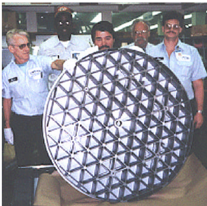
Figur 9. Sekundærspejlet af Beryllium har en letvægtsstruktur.
